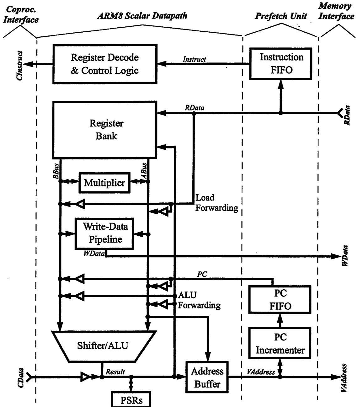
FIGURE 7.6 : ARM8 Data Flow Block Diagram [arm96b].
