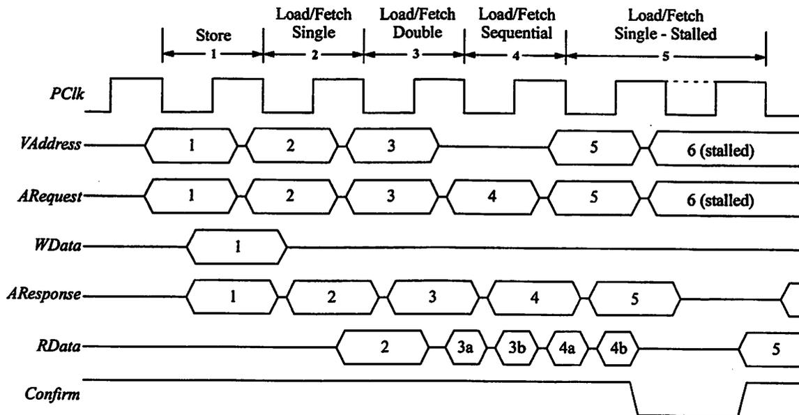
**FIGURE 7.8 : ARM8 Memory Interface Timing.**
