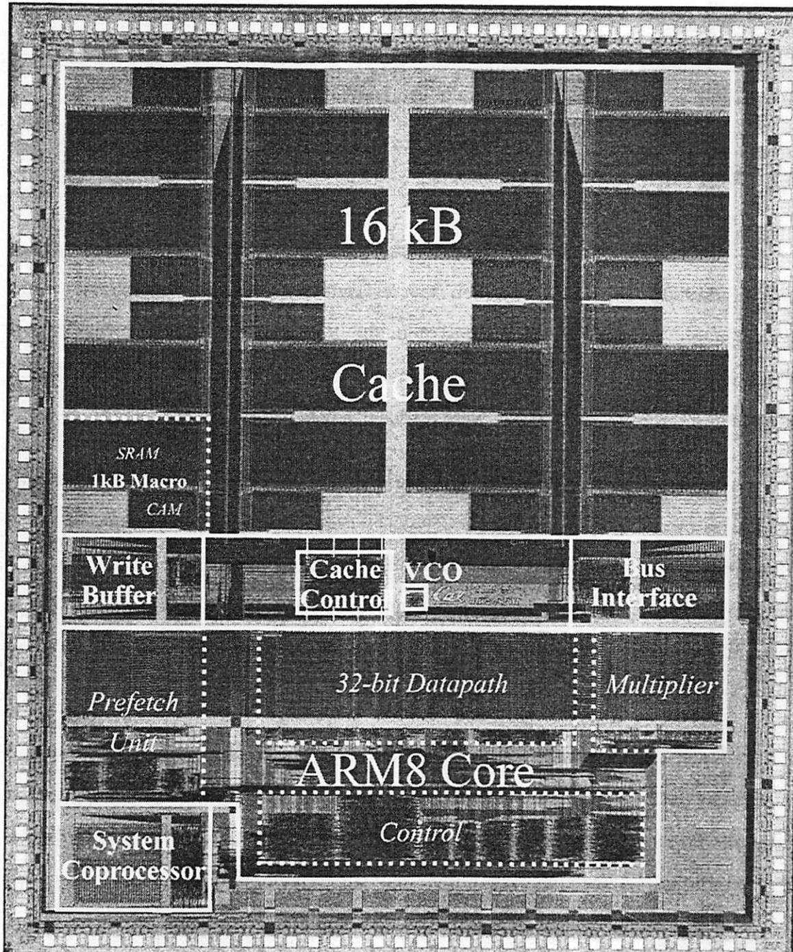
**FIGURE 7.2 : Microprocessor Die Photo.**
