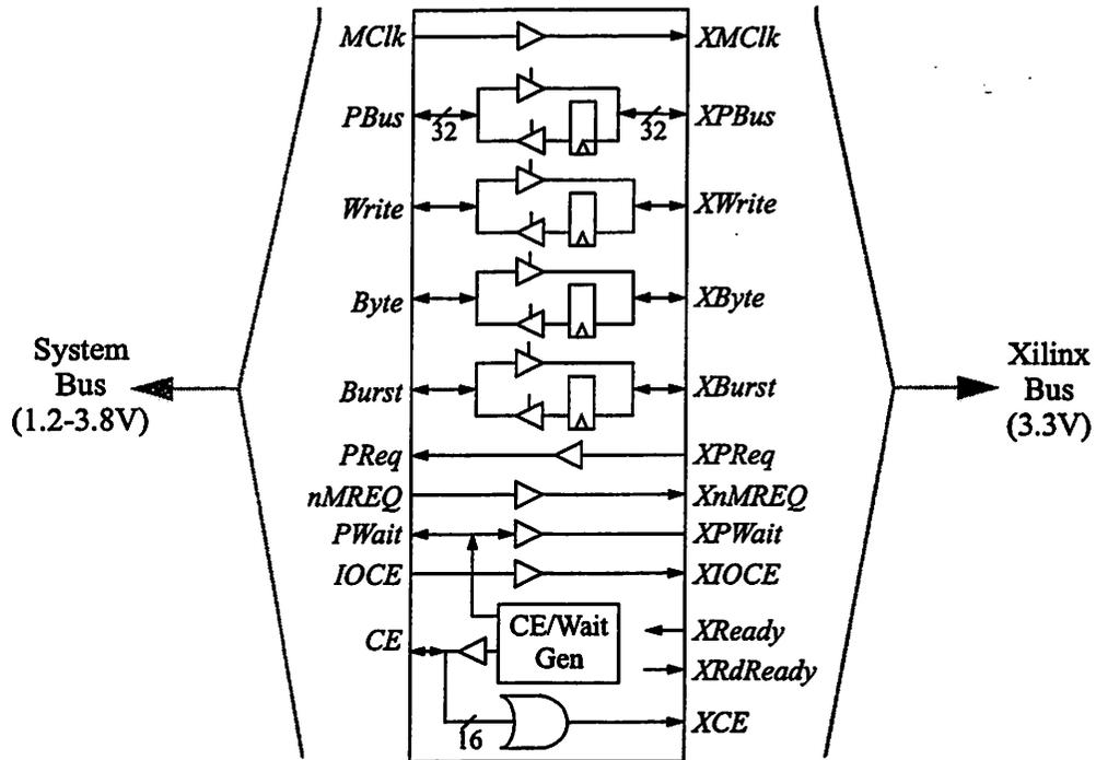
**FIGURE 7.36 : Interface Chip Block Diagram.**
