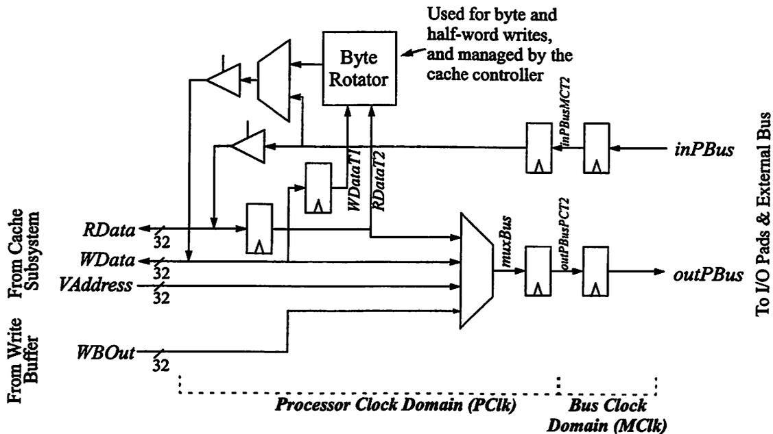
**FIGURE 7.21 : Bus Interface Architecture.**
